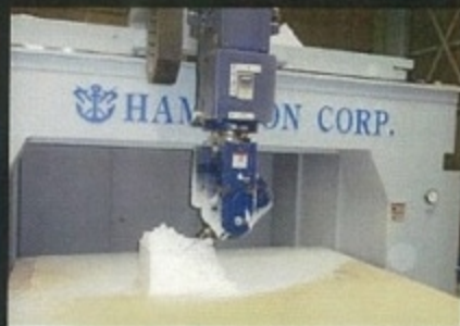
▲スキャンされたデータを元に、大型5軸NC加工機(NC7000U)で発泡スチロールが削られていく
