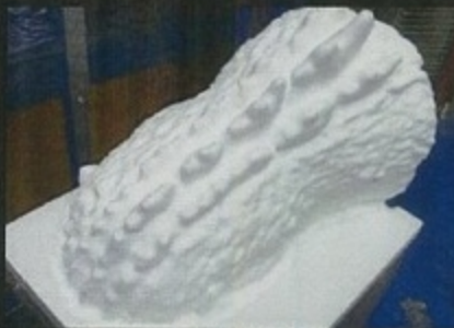
▲削り出されたゴジラの後頭部。ご覧のように出力は数パーツに分けて行っている
